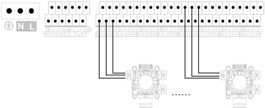
图 4-2 探测器主机接线示意图
